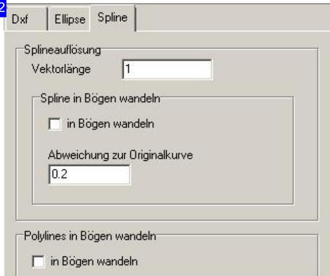
Unter dem Tab 'Spline' lassen diese sich in Vektoren und Bögen auflösen. Für die Auflösung in Vektoren, geben Sie die maximale Länge ein. Als Default wird hier 1 gesetzt.
