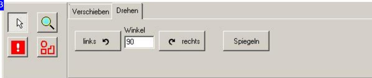
Um Teile zu drehen, markieren Sie ein Teil oder eine Teilegruppe, geben Sie die den Winkel für einen Step an und drücken Sie auf den Knopf in die gewünschte Drehrichtung.
