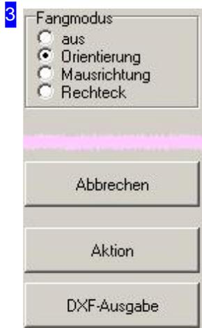
Im oberen Rahmen können Sie den Fangmodus für die automatische Annäherung durch das Programm bestimmen.
