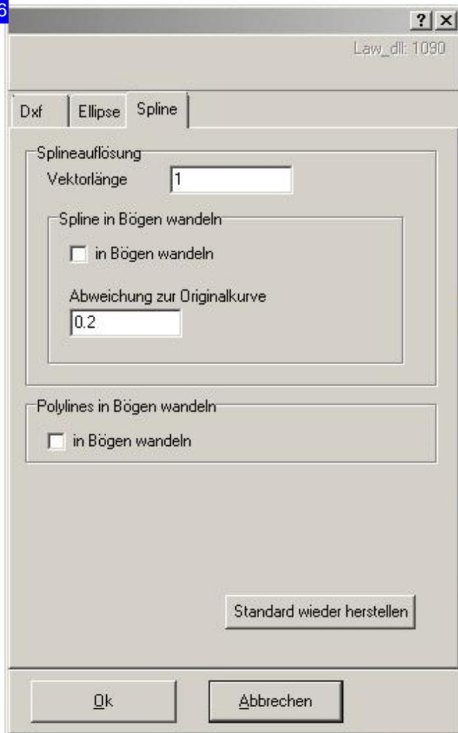
Im Dialog 'DXF-/DWG-Einleser' ist es möglich, Parameter vorzugeben, mit denen eine Manipulation bzw. Reduktion der einzulesenden DXF-Werte möglich ist. Lücken können geschlossen werden um geschlossenen Konturen zu erhalten und die Vektorlängen lassen sich für die Anwendung auf eine brauchbare, minimale Länge einstellen. Für die Bearbeitung von Ellipsen und Splines sind gesonderte Tabs vorhanden, um die Besonderheiten dieser Konturen zu manipulieren und diese zu vereinfachen.
