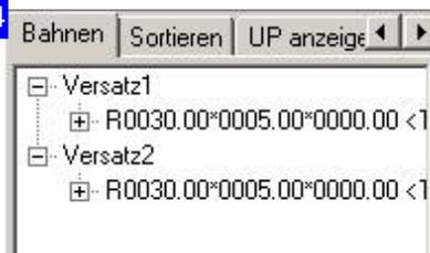
Nach dem Nachsetzen der Pratzlen ist die zuvor über die gesamte Platte erzeugten Sortierliste in zwei 'Versatzhälften' aufgeteilt. Für jeden Versatz gibt es jetzt einen Eintrag für einen Rechteckstempel 30 x 5 um die Teile zu stanzen.
