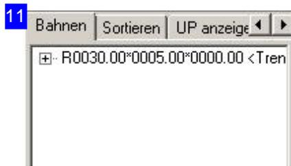
Nach dem Umsetzen der Konturen in Stanzbahnen werden die erzeugten Sortierlisten dargestellt; hier eine Sortierliste für einen Rechteckstempel 30 x 5 um alle Teile zu stanzen. Nach dem Nachsetzen wird diese Liste in 2 Hälften zerlegt.
