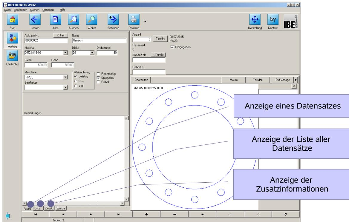
Im linken Teil des Fensters wird der gewählte Datensatz, eine Liste aller Datensätze oder die Zusatzinformation des aktuellen Datensatzes angezeigt. Drücken Sie auf den entsprechenden Tab unter dem Fenster, um auf die gewünschte Darstellung zu wechseln.
