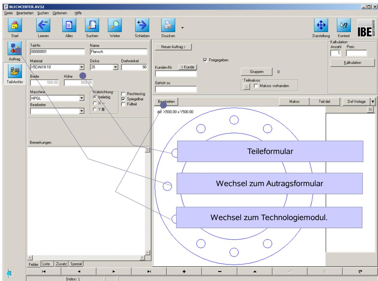
Tragen Sie alle Teiledaten in die entsprechenden Felder des Formulars und bestätigen Sie die Eingaben <sup>7</sup>. Das Teil erhält automatisch eine neue Teilenummer.
