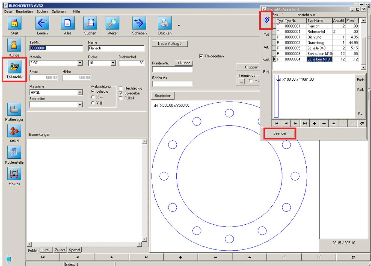
Gehen Sie im Hauptfenster in den entsprechenden Bereich Teile oder Artikel, wählen Sie das erforderliche Item und 'schieben' Sie es mit dem Knopf im Projektassistenten oben links in das Projekt. Bei einem Schneidteil können Sie den Preis jetzt durch das Programm kalkulieren lassen. Wählen Sie die Schaltfläche rechts im Assistenten.
