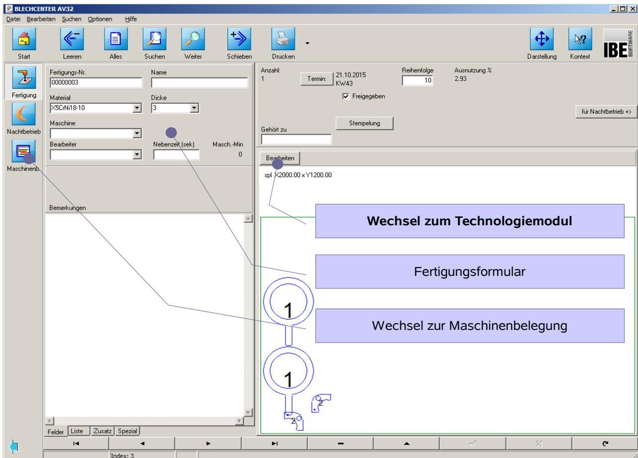
Die Fertigung kann dann komplett oder auch in Teilabschnitten erfolgen. Erstellen Sie einzelne Fertigungspläne, die Sie den Schneidmaschinen zuordnen und in die Belegungspläne der Maschinen einordnen können. Somit bietet Ihnen die AV32 eine optimale Planung und Nutzung Ihrer Maschinen.
