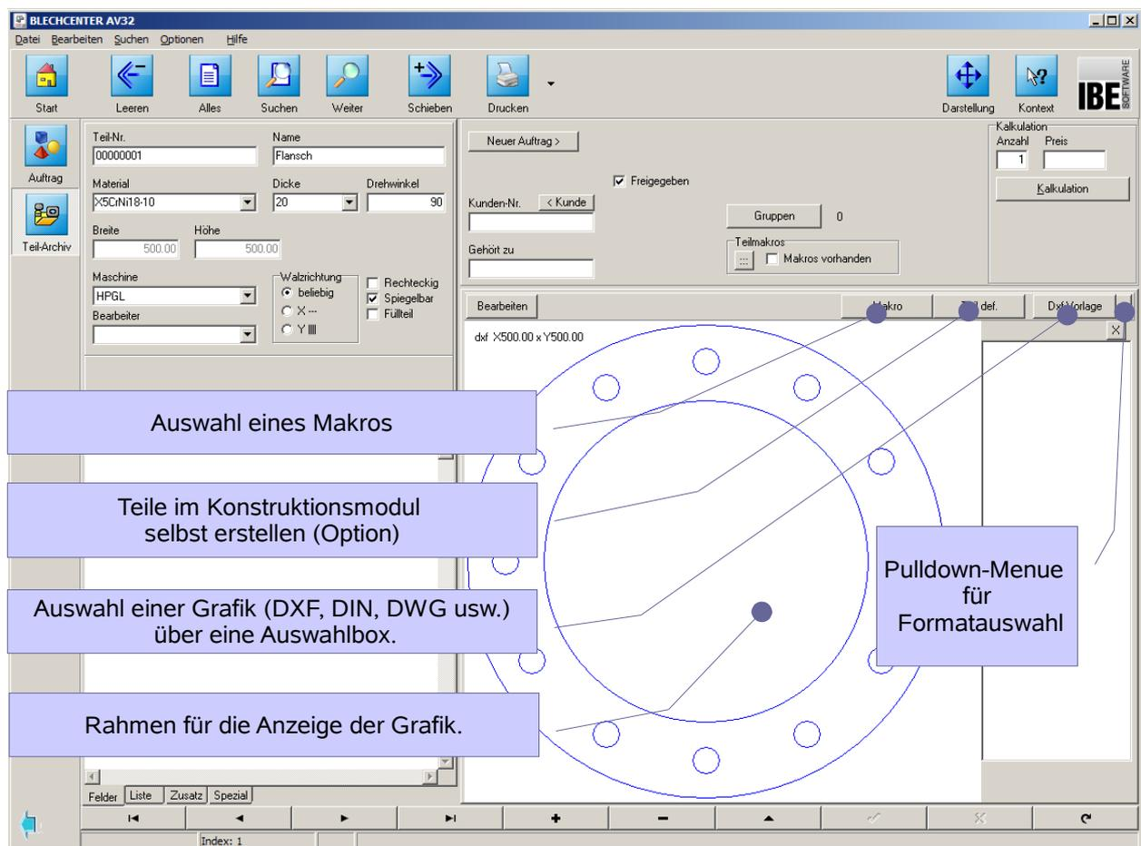
Das ausgewählte/erstellte Teil wird im Grafikrahmen angezeigt. Defekte DXF-Dateien können mit dem DXF-Analyser geprüft und die Fehler behoben bzw. die Zeichnung bereinigt werden.
